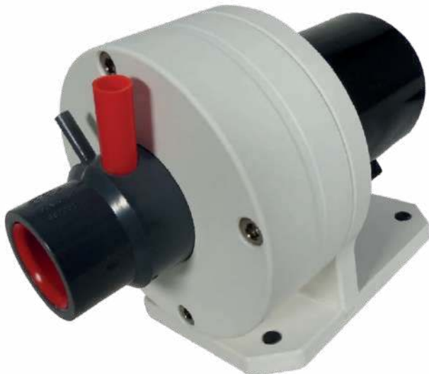
Bubble King® DC 24 В с блоком управления, мощностью не более 67 Вт, с индикацией оборотов в минуту и мощности
